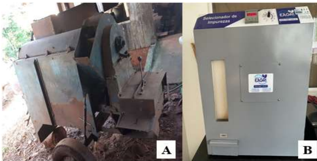
Figura 6 – Trilhadora de grãos de trigo (A); Sintel para eliminar as impurezas dos grãos (B).
