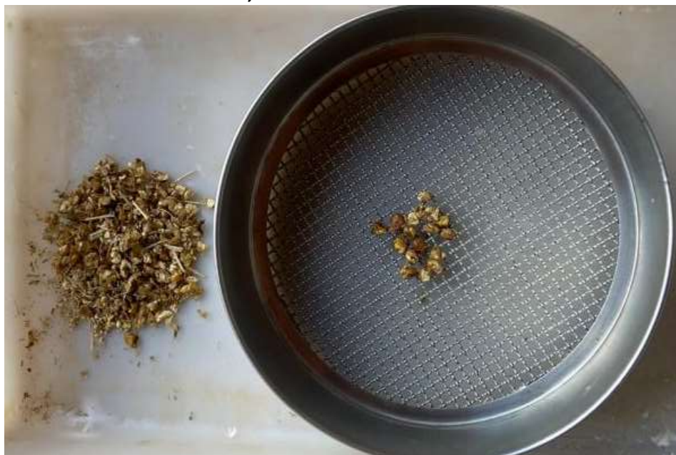
Figura 6 – Resultado da avaliação do processamento de grãos da silagem pela metodologia do KPS, onde o valor encontrado foi de 82%.
