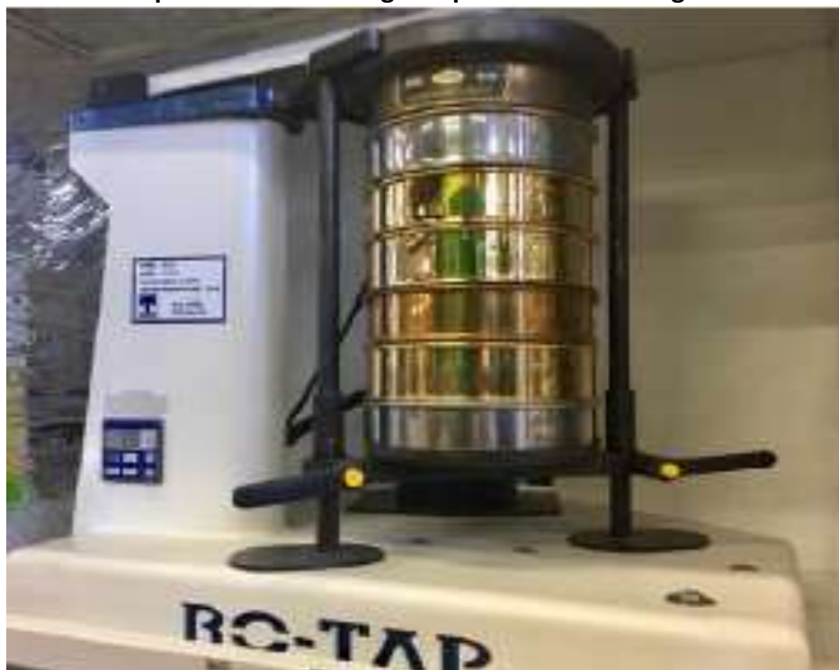
Figura 7 - Sistema de peneiramento Ro-Tap utilizado na análise de laboratório para avaliar o processamento de grãos presentes na forragem de milho.
