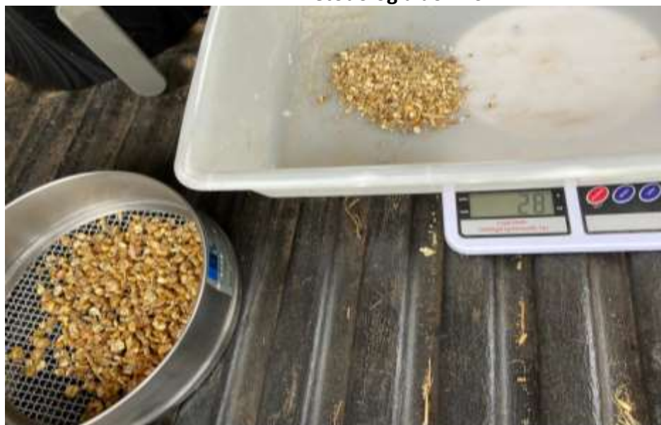
Figura 4 – Quarto passo para avaliação do processamento de grãos da forragem pela metodologia do KPS.
