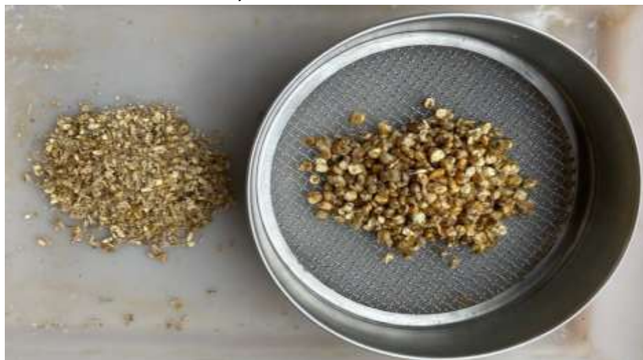
Figura 5 – Resultado da avaliação do processamento de grãos da silagem pela metodologia do KPS, onde o valor encontrado foi de 26%.
