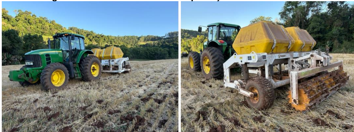
Figura 2 – Alternativa de descompactação mecânica do solo.
