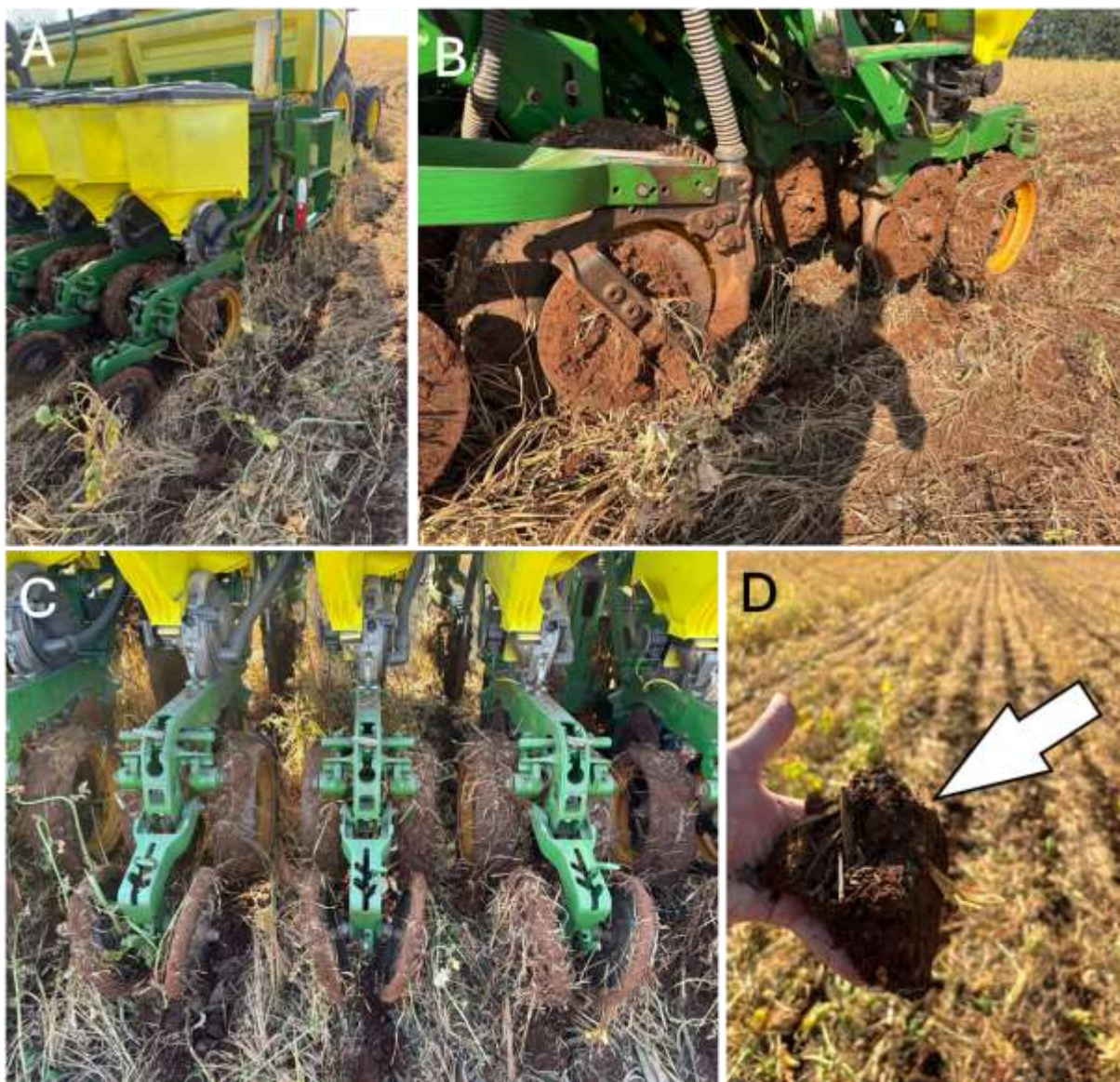
Figura 9 - Excesso de umidade na semeadura (A e B), necessidade de ajuste na regulagem da semeadora (C) e torrões devido alta umidade (D).
