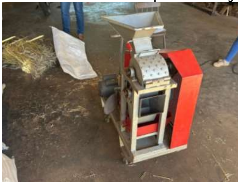
Figura 3 – Colhedora estacionária usada para trilha do trigo colhido.
