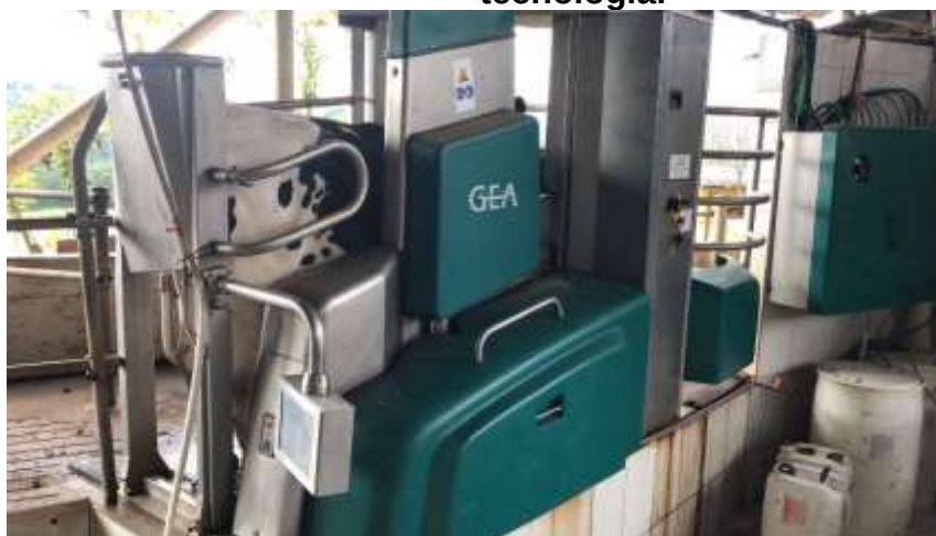
Figura 8 - Robô utilizado para fazer a ordenha, demonstrando o avanço da tecnologia.
