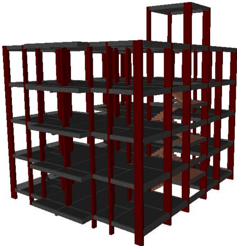
Figura 03- Estrutura em Concreto Armado - 3D
