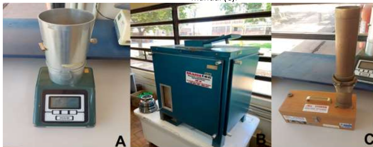
Figura 2 – Medidor de umidade de grãos (A); Medidor de impurezas (B); Medidor de PH manual (C).
